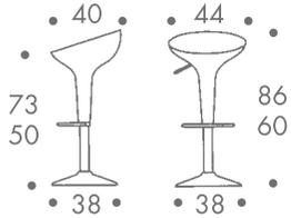
pneumatisch stufenlos höhenverstellbar
